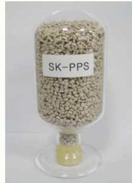
▲ SK PPS 수지와 이를 성형해 만든 자동차, 전기/전자, 산업 용도의 부품
